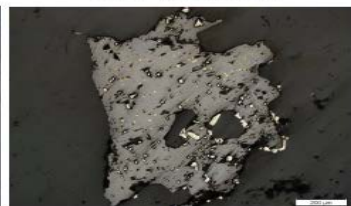
黄铜矿在闪锌矿中呈固溶体分离结构
