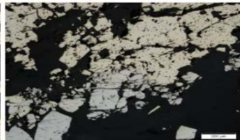
黄铁矿-毒砂呈交代结构
